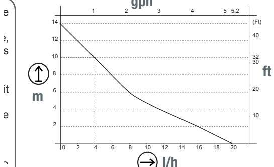
↑ Discharge / Hauteur de refoulement / Altezza di mandata / Förderhöhe → Capacity / Débit / Fördermenge / Portata
